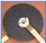
schnell wechselbare Trennscheibe
