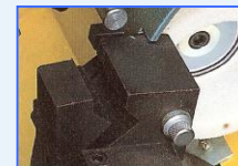
Schnellspannvorrichtung mit Einhebelbedienung für Durchmesser von 1-25 mm
