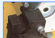
Schnellspannvorrichtung mit Einhebelbedienung für Durchmesser von 1-25 mm
