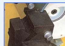
Schnellspannvorrichtung mit Einhebelbedienung für Durchmesser von 1-25 mm
